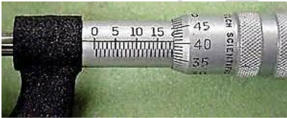
الشكل(5): آلية قراءة الأبعاد باستخدام الدوارة اللولبية.
